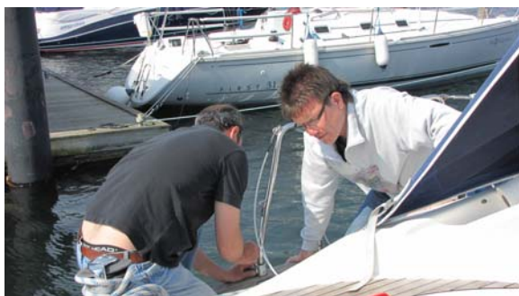
Reparatur der Relingsstütze
